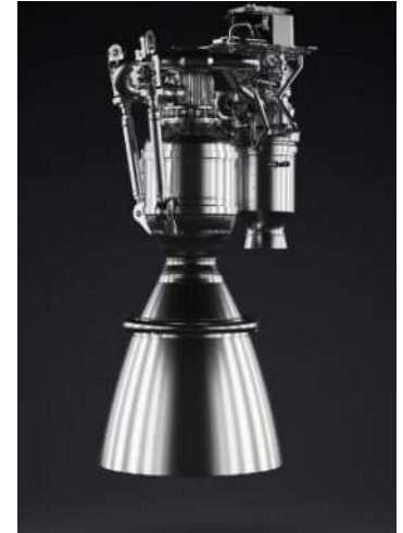
Imagen 10. Motor Merlin, de SpaceX. El Falcon 9 se llama así porque tiene 9 motores como este.
