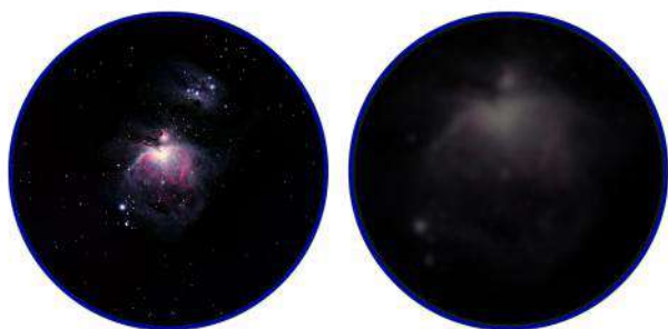
Fig. 3: Una imagen con más aumentos suele ser más borrosa, menos brillante y con menos campo
